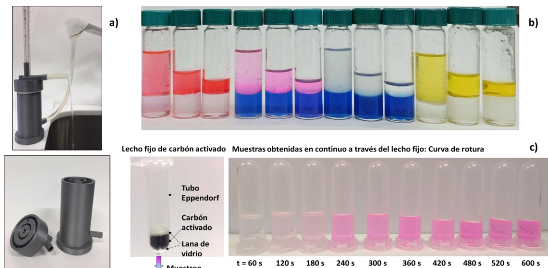
Figura 1. Imágenes de las instalaciones y prácticas desarrolladas. a) Cambiador de calor de tubos concéntricos diseñado e impreso en 3D. b) Práctica de extracción líquido-líquido. c) Práctica de adsorción en lecho fijo.
